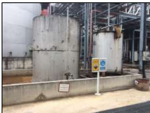
รูปที่ 2-39 ถังเก็บ NaOH
